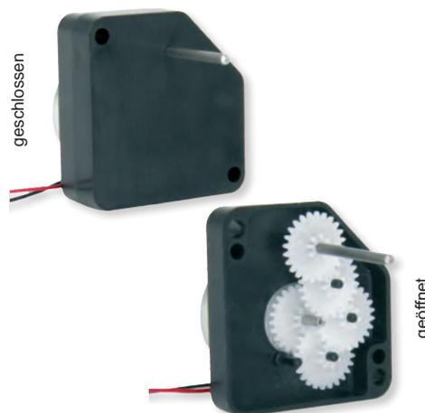
Äußerst vielseitig einsetzbares Getriebe. Je nach Anzahl der eingesetzten Zahnräder kann die Drehzahl von sehr langsamen 2,5 U/min bis zu schnellen 720 U/min variiert werden. Von der langsamen Windmühle bis zum rasanten Fahrzeugantrieb ist alles möglich. Dank des großen Spannungsbereiches ist das Getriebe für Solaranwendungen ebenso geeignet wie für Batteriebetrieb, auch als Generator einsetzbar, Befestigung über 2 Bohrungen mit Ø 3 mm.
