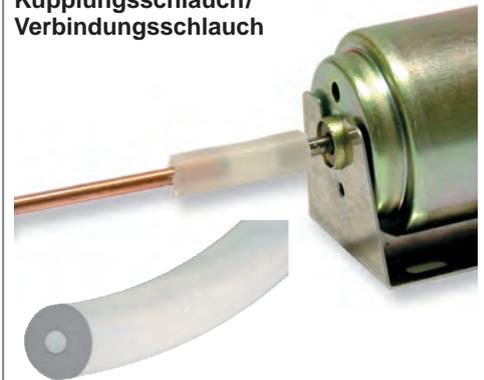
Zum Herstellen einer kraftschlüssigen Verbindung/Kupplung zwischen 2 Wellen wie zB. Schiffsantrieb, passend für Wellen von Ø 2 mm–max. Ø 5 mm. Einfache Montage durch Aufstecken (bei 5 mm Wellen: anwärmen erforderlich), hochwertiger und dauerhafter Silikonschlauch.
