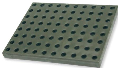
Lochplatte für das Winkler Klemmsystem: Auf- und Abbau von Elektronik - Schaltungen ohne Werkzeug und ohne Lötten. Durch das praktische 10,2 mm Rastermaß können auch Bauteile mit kürzeren Drähten gut eingesetzt werden. (PHILIPS/Schuco System: 15 mm)
