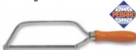
Die millionenfach bewährte Handbügelsäge mit Holzheft. Aus 6 mm Rundstahl, verzinkt, mit eingefrästen Spannnuten für das Sägeblatt. Für Stiftsägeblätter mit Länge: 149 mm, inklusive 1 Sägeblatt.
