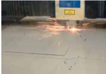
Um auch zukünftig den Produktionsstandort Deutschland sicher zu stellen, setzen wir für die Fertigung unserer Öfen modernste Maschinen ein. Alle Blechteile der Öfen werden z.B. auf einer Laserschneidanlage präzise zugeschnitten.
