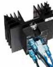
Halbleiterrelais zur Ansteuerung der Ofenheizung. Geräuscharm im Betrieb und nahezu verschleißfrei schalten die Halbleiterrelais in kurzen Takten zur optimalen Angleichung des Temperaturverlaufes an die Brennkurve.
