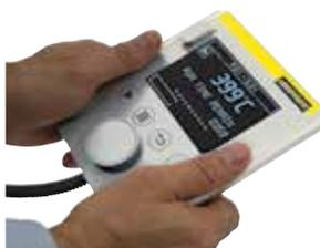
Controller zur einfachen Bedienung abnehmbar
