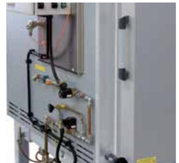
Gasstrecke und Thermoelement am Kammerofen
