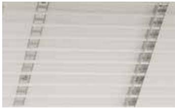
Dicht nebeneinander angeordnete Deckenheizelemente für direkte und gleichmäßige Bestrahlung des Glases.
