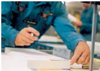
Bei der Isolierung unserer Öfen gehen wir keine Kompromisse ein. Jeder Ofen wird in Handarbeit ausgemauert. Alle Isolationsmaterialien sind handverlesen und werden präzise in den Ofen eingesetzt. Regelmäßige Qualitätskontrollen aller Materialien stellen die Langlebigkeit des Ofens sicher.
