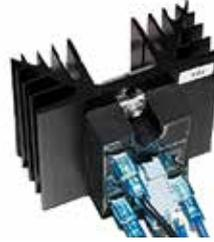
Die Toplader werden serienmäßig mit Halbleiterrelais ausgerüstet, die die Heizung während des Brandes geräuscharm schalten.
