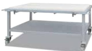
Tische zur Erweiterung des Ofensystems für Modelle GFM; Wechseltischsystem zur Nutzung der Restwärme des Ofens und zur Verkürzung der Zykluszeiten durch Tischwechsel im warmen Zustand.
