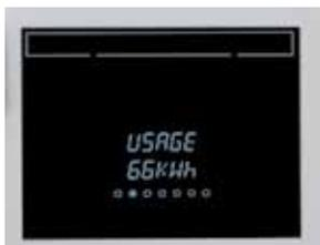
Anzeige des Stromverbrauches in kWh
