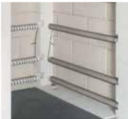
Freie Wärmeabstrahlung durch Heizelemente auf keramischen Trägerrohren; optimale Positionierung für eine sehr gute Temperaturgleichmäßigkeit. (N 500 E, N 100 - N 2200/H, NW 150 - NW 1000/H)
