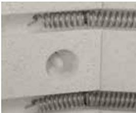
Thermoelement geschützt in der Isolierung eingebaut.
