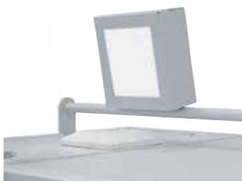
Motorische Abluftklappe bei Kammeröfen N 500 E
