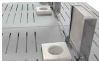
Abluftklappe motorisch gesteuert für ein beschleunigtes Abkühlen des Ofens nach abgeschlossenem Brand.
