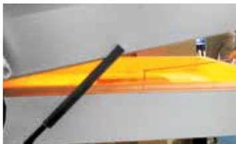
Leichtes Öffnen und Schließen der Haube, unterstützt durch Gasdruckdämpfer.
