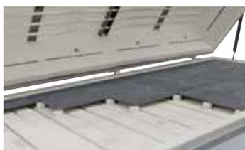
Bodenheizung für gleichmäßige Durchwärmung großer Objekte.
