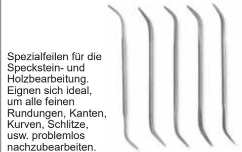
Spezialfeilen für die Speckstein- und Holzbearbeitung. Eignen sich ideal, um alle feinen Rundungen, Kanten, Kurven, Schlitz, usw. problemlos nachzubearbeiten.
