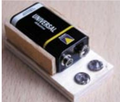
**Bild 3: Das Grundbrett mit Reißzwecken und aufgeklebten Seitenteilen**
