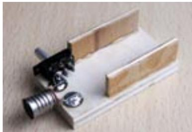
**Bild 4: Hier sind der Schalter eingeklebt, die Fassung aufgelötet und ein Anschlussdraht angelötet worden.**
