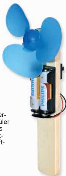
Ein idealer und einfach herzustellender Frischluftspender, der an heißen Sommertagen zum besten Freund wird. Die Schüler lernen dabei, einen einfachen Stromkreis mit Schalter aufzubauen. Sehr hohe Luftleistung durch eine speziell geformte Luftschraube (Ø 90 mm).
