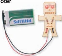
Dieser Bausatz entstand für die Make-Munich 2016 und ist perfekt für absolute Lötmeister geeignet. Die LEDs und Widerstände werden auf einem vorgelaserten Sperrholzplättchen verlötet. Am Ende der Übung hat man einen kleinen Holz-Roboter mit leuchtenden Augen.
