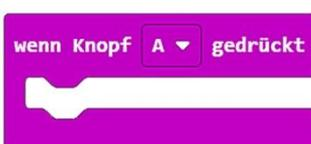
Bei einem Klick auf **Knopf A** des Micro:bit wird der Programmblock innerhalb der Klammer ausgeführt. Mit der Pfeilauswahl kann man weitere Knöpfe aktivieren: **B** und **A+B**
