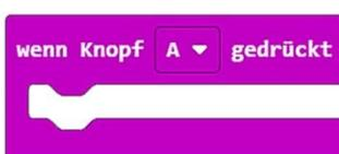
Bei einem Klick auf **Knopf A** des Micro:bit wird der Programmblock innerhalb der Klammer ausgeführt.
