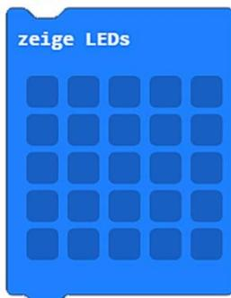
Diese Funktion stellt die **Micro:bit LED-Anzeige** mit 25 LEDs dar. Durch Anklicken der dunkelblauen Felder kann man die einzelnen LEDs an- und ausschalten und damit eigene Symbole erstellen.
