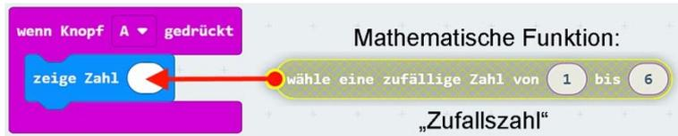
Vorgabe: Nach Betätigung von **Knopf A** soll auf dem Micro:bit eine **zufällige Zahl von 1 - 6** angezeigt werden. Der Micro:bit wird dadurch zu einem praktischen **Zahlenwürfel**.
