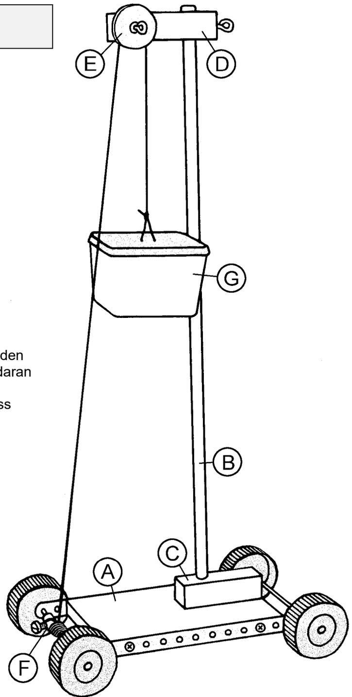
2. Säge Leiste (C)-(50 x 15 x 15 mm) und Leiste (D)-(60 x 15 x 15 mm) von der Lindenholzleiste (120 x 15 x 15 mm). Zeichne die Bohrungen laut Plan an und bohre sie den Angaben entsprechend. Befestige das rote Rillenrad (E) mit einer Ringschraube seitlich so an Leiste (D), dass sich das Rillenrad (E) noch locker drehen lässt. Fixiere dann Leiste (D) mit einer stirnseitigen Ringschraube an einem Ende des Rundstabes (B)-( $\varnothing 8$  x 490 mm).
