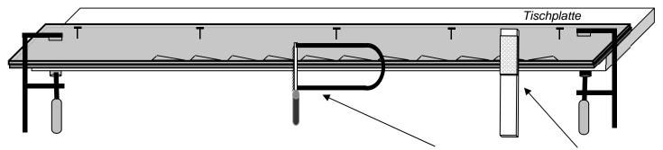
7. Die beiden zusammengenagelten Leisten werden gemeinsam gesägt und gemeinsam geschliffen! Zum Schleifen wird das Werkstück an der Tischkante mit 2 Schraubzwingen befestigt. Ein Stück Schleifpapier straff um die Bodenleiste gebogen ergibt ein gutes Schleifwerkzeug. Alle Schnittstellen solange schleifen, bis sie ganz glatt sind!
