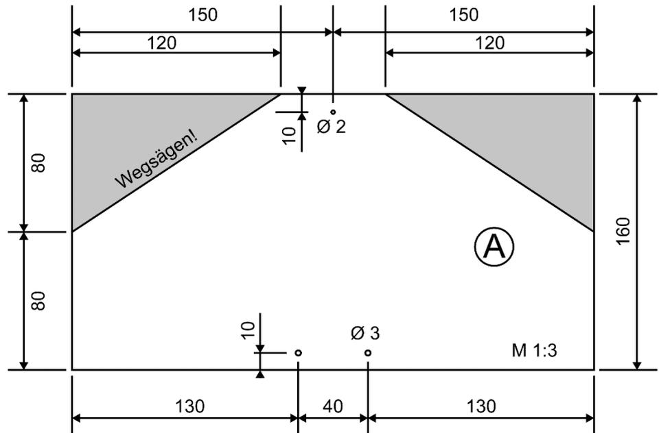
2. Übertrage die vier  $\varnothing 2$  mm Bohrungen den Angaben entsprechend auf die Sperrholzleiste (B)- (240 x 70 x 20 mm). Die zwei Bohrungen auf der Oberseite werden 10 mm tief und die zwei stirnseitigen Bohrungen 20 mm tief gesetzt. Befestige anschließend die Teile (A) mit zwei Spanplattenschrauben 3 x 30 mm und etwas Leim an der vorgebohrten Stirnseite von Brett (B). Vor dem Weiterbau sollten die Holzteile (A) und (B) lackiert werden. Wir empfehlen dazu schnell trocknende Acryllacke.
