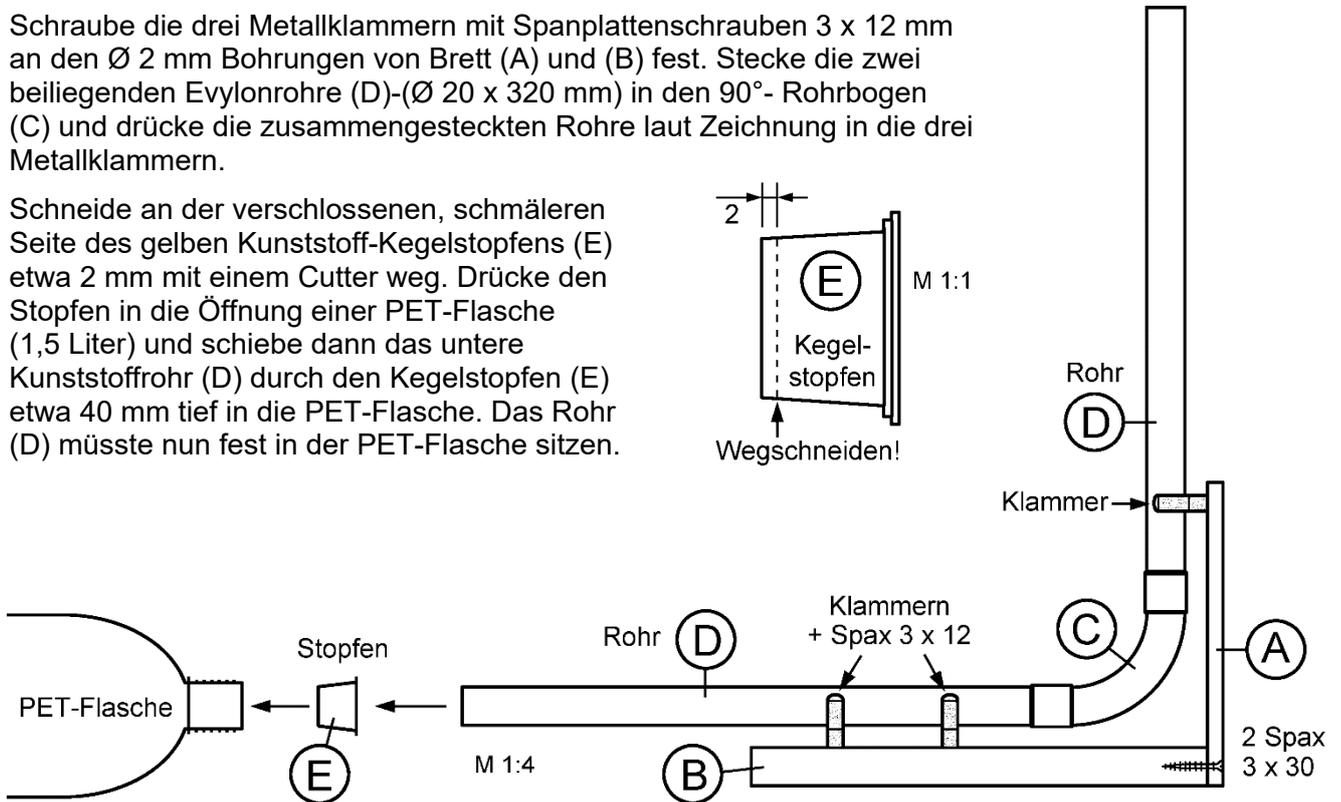
**Ein Tipp:** Geübte Bastler können die Verbindung zwischen PET-Flasche und Rohr (D) auch ohne Kegelstopfen (E) aus dem Drehverschluss der PET-Flasche herstellen. Man muss dazu allerdings ein  $\varnothing$  20 mm Loch mit einem Forstnerbohrer von oben mittig in den Drehverschluss bohren, den Verschluss ca. 40 mm auf das Rohr (D) schieben und die Flasche anschrauben.
