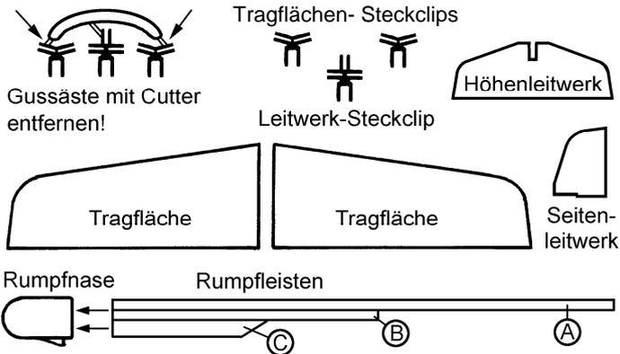
Leime die Leisten (A)-(320 x 5 x 3 mm) u. (B)-(160 x 5 x 3 mm) an der schmalen Seite zusammen. Schräge Leiste (C)-(100 x 10 x 3 mm) ab und schiebe sie zusammen mit den Leisten (A) und (B) vorerst ohne Leimzugabe in die Rumpfnase.
