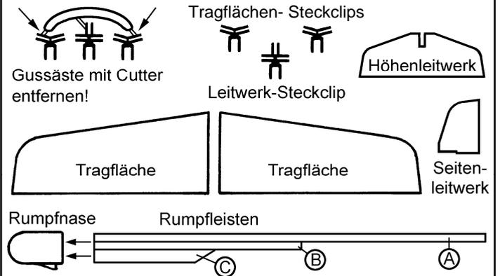
Leime die Leisten (A)-(320 x 5 x 3 mm) u. (B)-(160 x 5 x 3 mm) an der schmalen Seite zusammen. Schräge Leiste (C)-(100 x 10 x 3 mm) ab und schiebe sie zusammen mit den Leisten (A) und (B) vorerst ohne Leimzugabe in die Rumpfnase.
