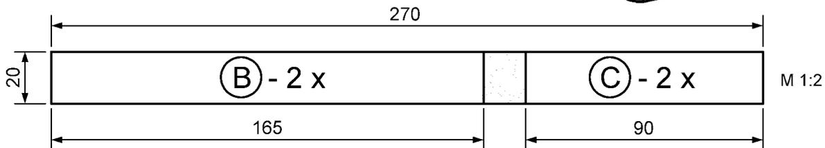
2. Die untere (C)-Leiste (90 x 20 x 15 mm) muss mittig ca. 30 mm breit mit einer Halbrundfeile etwa 5 mm tief abgeschragt werden, damit spater die Kaugummikugeln aus dem Gehause herausrollen.
