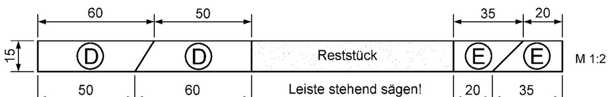
4. Leime die vier Leisten (D) und (E) der nebenstehenden Zeichnung entsprechend in das Gehäuse auf die Rückwand (A).
