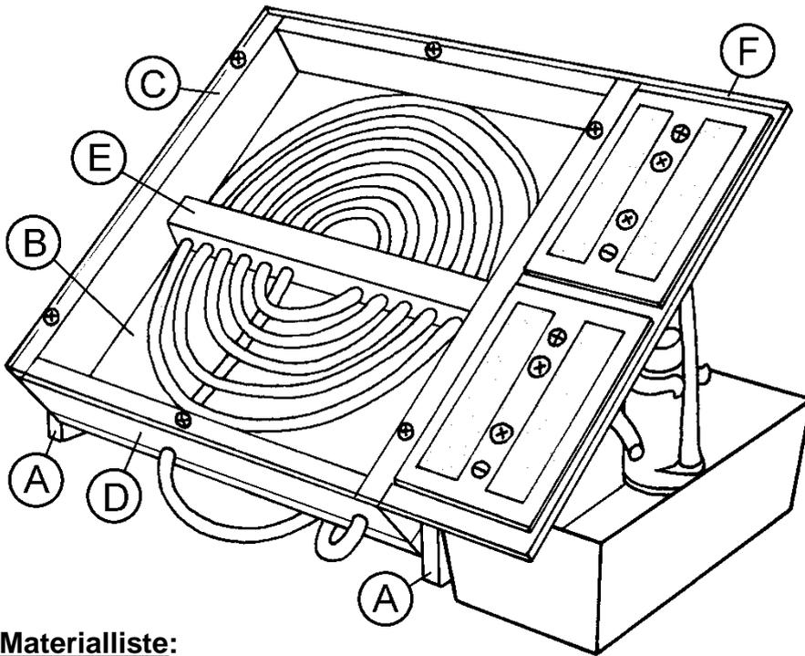
Dieser funktionstüchtige Sonnenkollektor erhitzt Wasser in etwa einer Stunde auf mehr als 60°C. Das schwarze Gehäuse absorbiert Sonnenlicht, wandelt es in Wärme um und erwärmt das durchlaufende Wasser. Der Motor der Kreislumpe wird dabei von zwei Solarzellen mit Strom versorgt.
