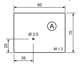
2. Zeichne die Ø 3,5 mm Bohrung auf Brett (A)-(90 x 70 x 10 mm) an und bohre sie mit einer Ständerbohrmaschine.
