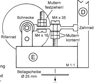
Schiebe das fertige Getriebe an der Ø 4 mm Bohrung von Teil (E) zusammen mit der Ø 25 mm Beilagscheibe auf die Senkkopfschraube M4 x 40 mm und sichere das Ende durch Aufschieben einer Gummischeibe.
