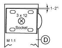
6. Befestige den Motorsockel mit einer Spanplattenschraube 3 x 12 mm im Winkel von ca. 1 - 2° nach hinten geneigt oben an der Ø 2 mm Bohrung von Leiste (D).
