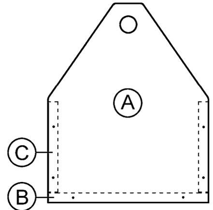
Auch in den zwei (A)-Teilen werden Nägel in Brettstärke eingeschlagen. Leime und nagle dann die zwei Bretter (A) auf die Teile (B) und (C).
