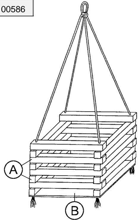
2. Leime 2 gebohrte (A)-Leisten auf die Bodenplatte (B). Nach dem Trocknen des Leims wird die Bodenplatte (B) an den 4 Löcher (Ø 5 mm) der 2 (A)-Leisten durchgebohrt. Schleife hernach alle Kanten mit feinem Schleifpapier nach.
