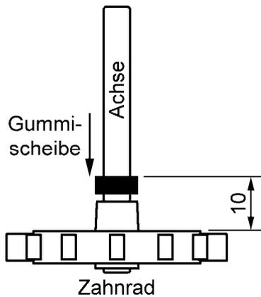
5. Schiebe die Achse in die Bohrung von Leiste (C) und stecke den Schranken auf die Achse. Sollte er nicht fest auf der Achse sitzen, dann lege beim Aufstecken ein leimgetränktes Schnurstück bei. Durch Betätigung der Kurbel kann nun der Bahnschranken geöffnet und geschlossen werden.
