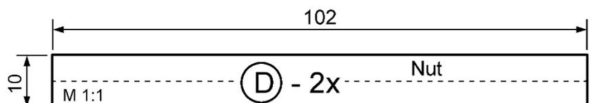
Ziehe die Schutzfolien von der Plexiglasplatte (150 x 100 x 3 mm) und schiebe sie zusammen mit der Graupappe in die Führungen der Nutleisten (D).
