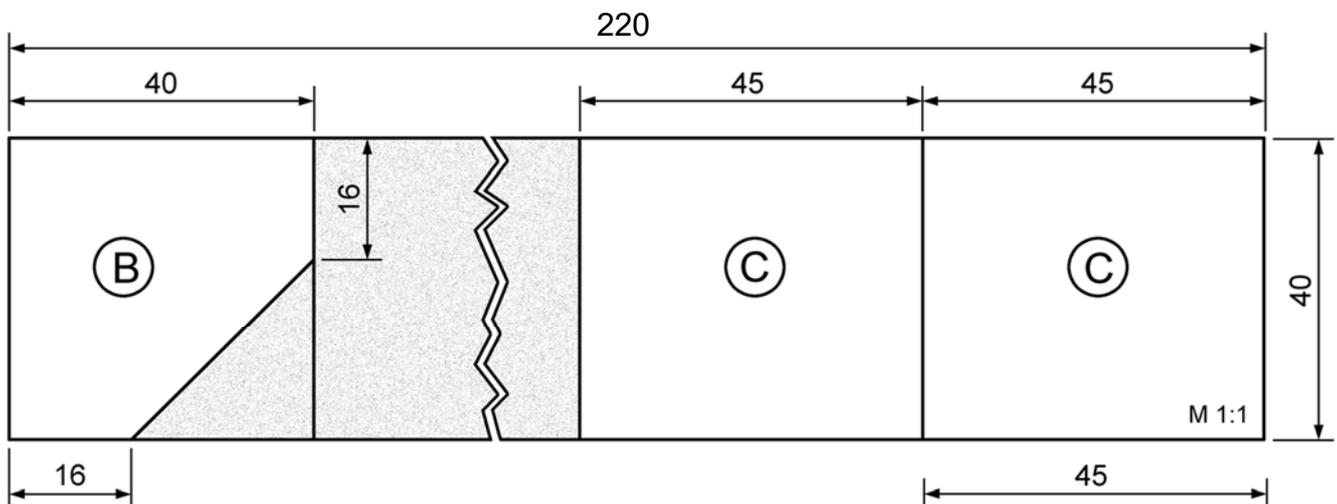
2. Leime die 2 Klötzchen (C) zusammen und bohre sie nach dem Abbinden des Leims laut Plan mit einem  $\varnothing 10$  Bohrer.
