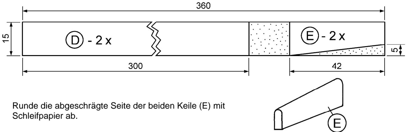
Runde die abgeschrägte Seite der beiden Keile (E) mit Schleifpapier ab.
