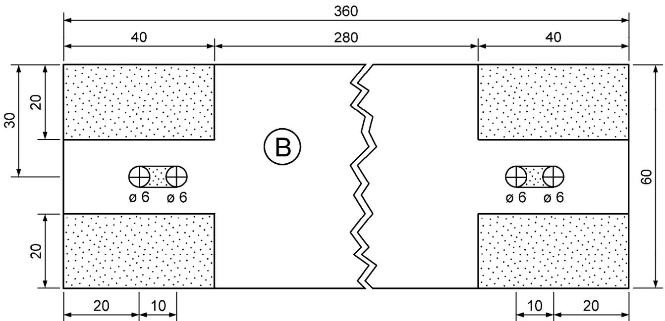
5. Stecke die zwei (A)-Teile auf die Zapfen von Leiste (B) und drücke die Keile (E) fest in die Schlitz. Befestige schließlich die drei Querleisten (C) und (D) mit Leim und Nägeln in den entsprechenden Aussparungen der Seitenleisten (A).
