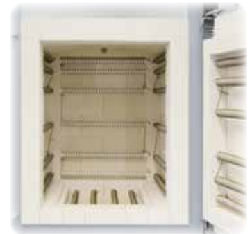
Öt oldali fűtés és a fűtőelemek speciális elrendezése az optimális hőeloszlás érdekében
