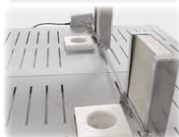
Motorikusan vezérelt szellőzőszelep a kemence felgyorsított lehűléséhez a lezárt égetés után.
