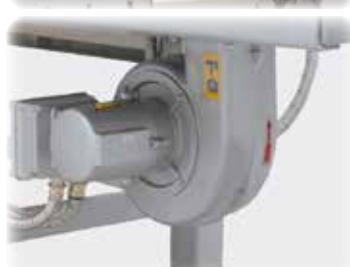
Hűtőventilátor a felgyorsított lehűléshez zárt fedél esetén
