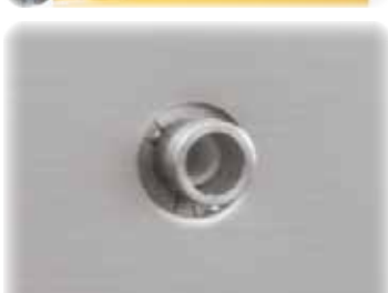
Kémlelőnyílás a kemenceajtóban (átmérő 20 mm)
