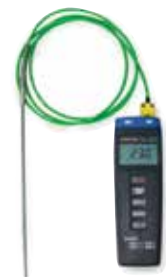
Könnyen kezelhető hőmérő a RAKU-kemence 100 rendszerhez, NiCr- Ni hőelem, 20 °C - 1200 °C fokig, Második érzékelő csatlakozási lehetőséggel
