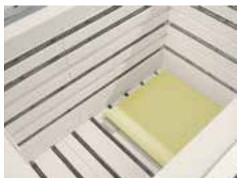
Felülről rakható kemence égetőtér 5 oldali fűtéssel
