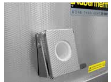
Kémlelő ablak a légbevezető nyílásokban az üveg megfigyeléséhez kiegészítő felszereléseként.
