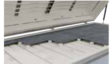
Padlófűtés nagyobb objektumok egyenletes átmelegítéséhez kiegészítő felszereléseként.
