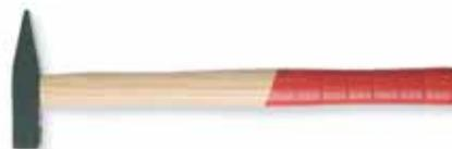
Lackierter und geschweifeter Eschenholzstiel, verkeilt und kunstharzvergossen, daher kein Wackeln mehr, Kopf im Gesenk geschmiedet und gehärtet, pulverbeschichtet, DIN 1041, GS geprüfte Qualität
