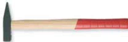
Lackierter und geschweißter Eschenholzstiel, verkeilt und kunstharzvergossen, daher kein Wackeln mehr, Kopf im Gesenk geschmiedet und gehärtet, pulverbeschichtet, DIN 1041, GS geprüfte Qualität
