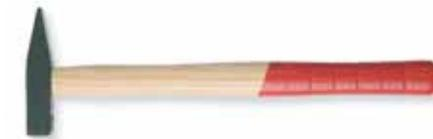
Lackierter und geschweifeter Eschenholzstiel, verkeilt und kunstharzvergossen, daher kein Wackeln mehr, Kopf im Gesenk geschmiedet und gehärtet, pulverbeschichtet, DIN 1041, GS geprüfte Qualität.
