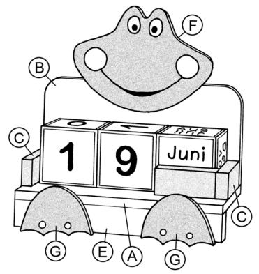
2. Länge die Sperrholzleiste (300 x 20 x 8 mm) den Angaben entsprechend am besten mit einer Gehrungssäge ab und schleife die Sägestellen etwas nach.
