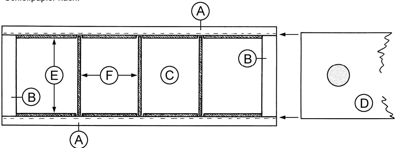
2. Nun wird der **Deckel (D)-(300 x 97 x 3 mm)** an die Nutleisten angepasst. Schleife das Brett an den langen Kanten mit feinem Schleifpapier ab, bis es sich gut in beiden Nutleisten (A) einführen lässt. Eine Fichtenscheibe (Ø 25 mm), auf den Deckel (D) geleimt, erleichtert später das Öffnen der Schatulle.
