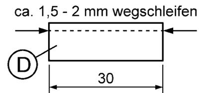
4. Leime nun die Teile (A), (B), (C) und (D) auf die zwei Leisten (F)-(170 x 10 x 5 mm). Achte besonders bei den Leimfugen darauf, dass es später zu keinen Luftaustritten kommt. Als Hilfe beim Zusammenleimen kann Leiste (E) eingeschoben werden. Diese Leiste darf aber nicht angeleimt werden. Ziehe sie also sofort nach dem Zusammenbau wieder heraus!
